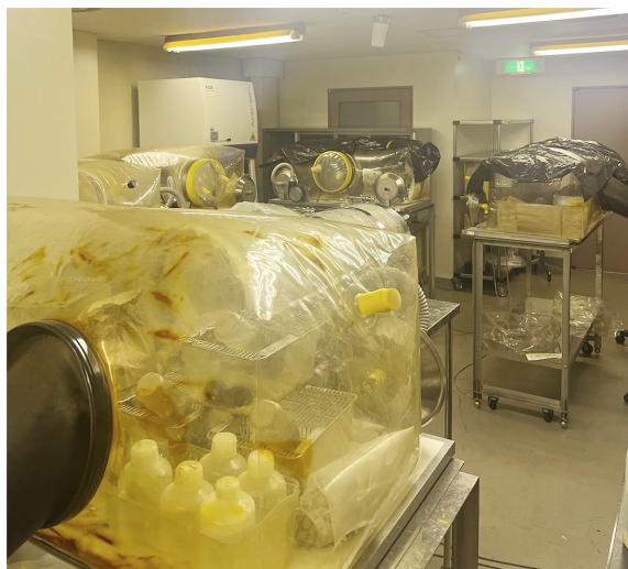
写真3 杏林大学医学部実験動物施設感染動物飼育区域内の無菌マウス飼育用ビニールアイソレーター
